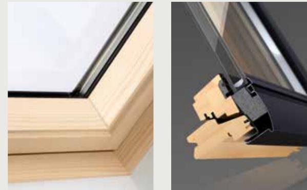
Le finestre per tetti VELUX vengono sottoposte a un trattamento per proteggere e mantenere inalterata nel tempo la naturale bellezza del legno, che consiste in due strati di verniceacrilica a base d'acqua intervallati da un'operazione di levigatura. Lungo il perimetro delle finestre in legno sono inseriti pannelli sagomati in EPS, un materiale che a parità di spessore è 3,7 volte più isolante del legno.
